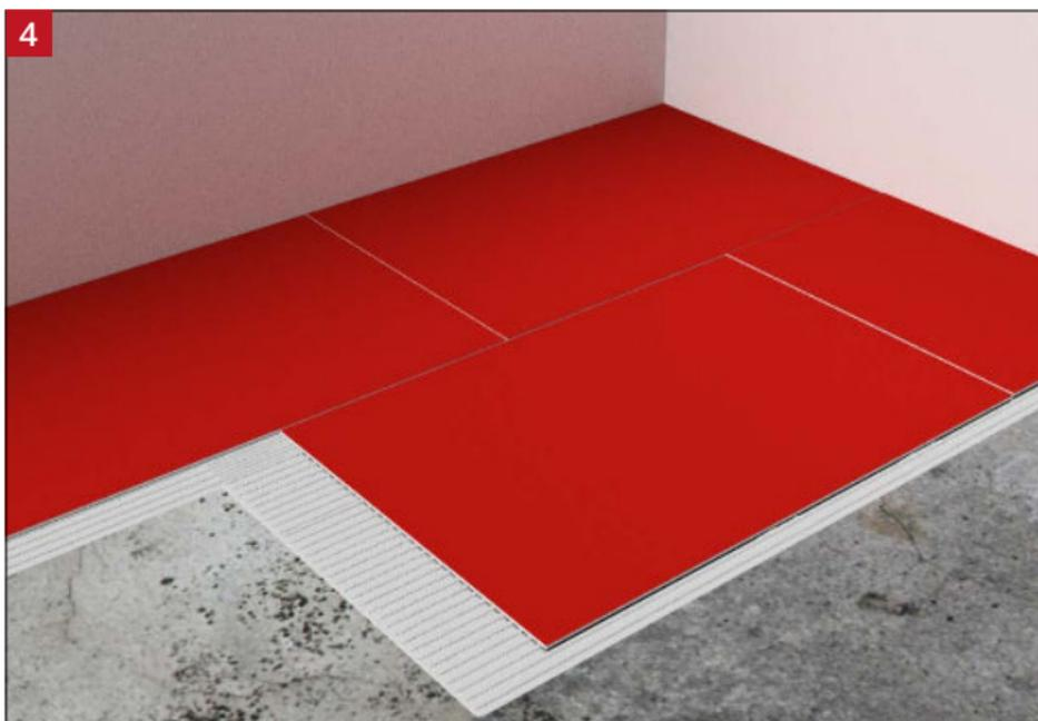
Die Ultralight muss auf ein frisch mit einem Zahnschachtel aufgetragenes Kleberbett gebettet und gründlich in den Kleber eingedrückt werden, um sicherzustellen, dass unter den Platten keine Hohlräume verbleiben. Alle Platten müssen im Versatz verlegt werden.
