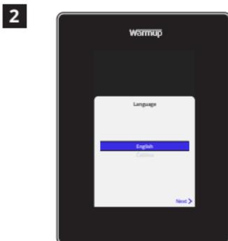
Bringen Sie das Display wieder an, bis ein „Klicken“ zu hören ist. Schalten Sie den Stromkreis wieder ein und schalten Sie den Thermostat ein. Befolgen Sie die Anweisungen auf dem Bildschirm, um das System einzurichten. Nach dem Einrichten wird ein QR-Code angezeigt.
