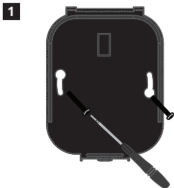
Führen Sie die Befestigungsschrauben durch die Befestigungslöcher der Wandhalterung und ziehen Sie diese fest.
