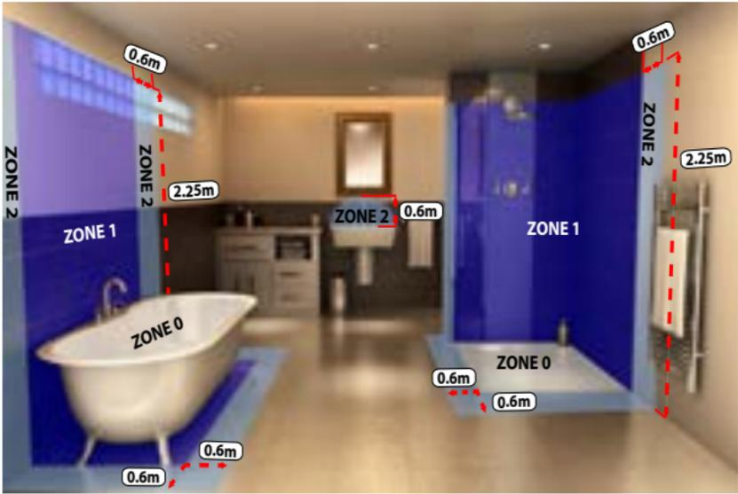
**HINWEIS:** Bei der Installation im Badezimmer muss das Thermostat außerhalb der Schutzzone 0 und 1 installiert werden.
