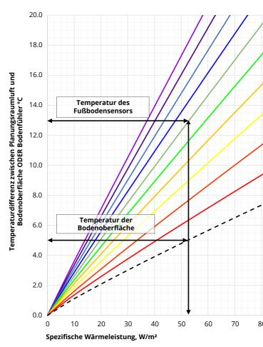
Anhand des obigen Diagramms kann die spezifische Heizleistung einer elektrischen Fußbodenheizung auf Grundlage des Temperaturunterschieds zwischen der Raumlufttemperatur und der Fußbodenoberfläche oder der Temperatur des Fußbodensensors je nach Bodenbelag ermittelt werden.
