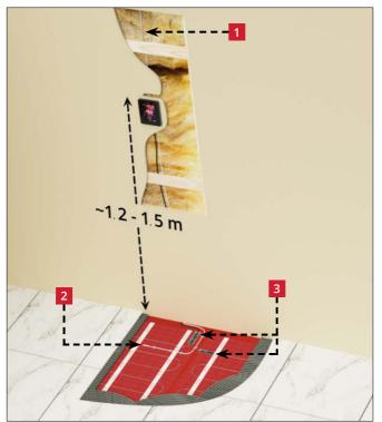
Die Zuleitung zum Thermostat MUSS immer durch einen 30mA RCD oder RCBO geschützt sein. Zeitverzögerte RCDs oder RCBOs dürfen nicht verwendet werden. An jeden 30-Milliampere-RCD oder RCBO sollten nicht mehr als 7,5 kW Heizleistung angeschlossen werden. Für größere Lasten sind mehrere RCDs oder RCBOs zu verwenden.
