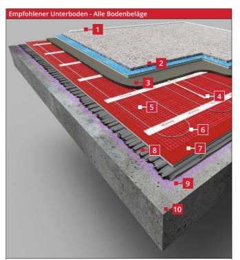
1 Randdehnsstreifen Um unterschiedliche Bewegungen zwischen dem fertigen Fußboden und den Wänden zu ermöglichen
