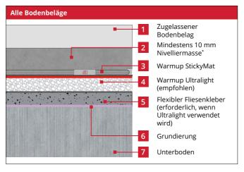
Diese Methode kann verwendet werden, um eine Bodenoberfläche zu schaffen, die für die meisten Bodenbeläge geeignet ist, und um ein Abflussgefälle in einer Nasszelle zu schaffen. Die Ausgleichsmasse muss in einer einzigen Schicht aufgetragen werden. Zusätzliche Schichten von Ausgleichsmassen dürfen nicht hinzugefügt werden. Erkundigen Sie sich beim Bodenbelagshersteller nach der Eignung für Fußbodenheizungen.
